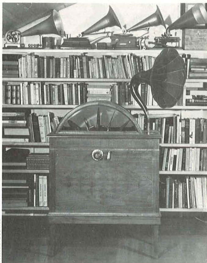
Juke-box Giacardi (Milano) del 1920. La selezione manuale è fra 15 dischi ad incisione verticale, il riproduttore è a punta di zaffiro.
