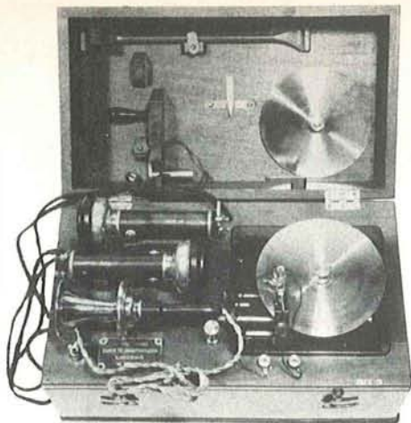
Telegrafo Poulsen a dischi metallici, 1903.
