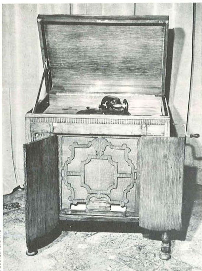
Decca a tromba ortofonica e a velocità regolabile, fine anni Venti.
