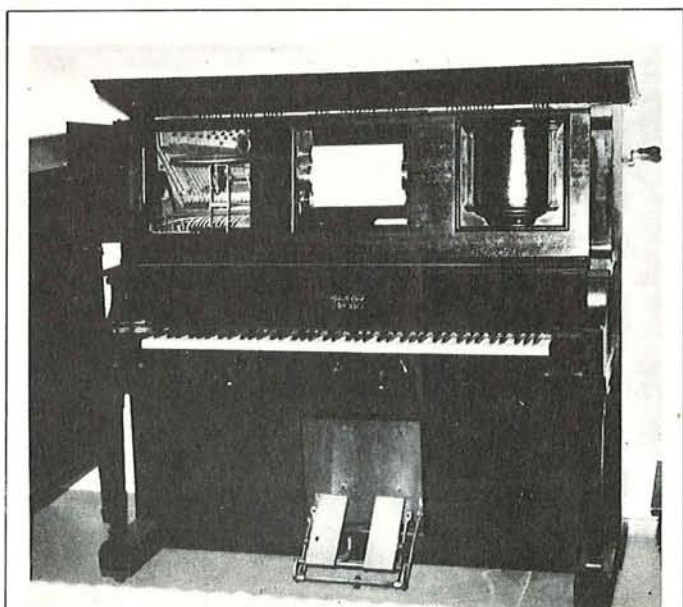
Un player-piano Melville-Clark «Apollo» incorporante un giradischi grammofonico sincronizzato.
