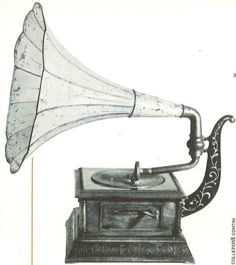
3, 4, 5 - Grammofono Pathé a motore elettrico, 1909. Macchina per la lettura dei dischi da 50 cm di diametro ad incisione verticale.
