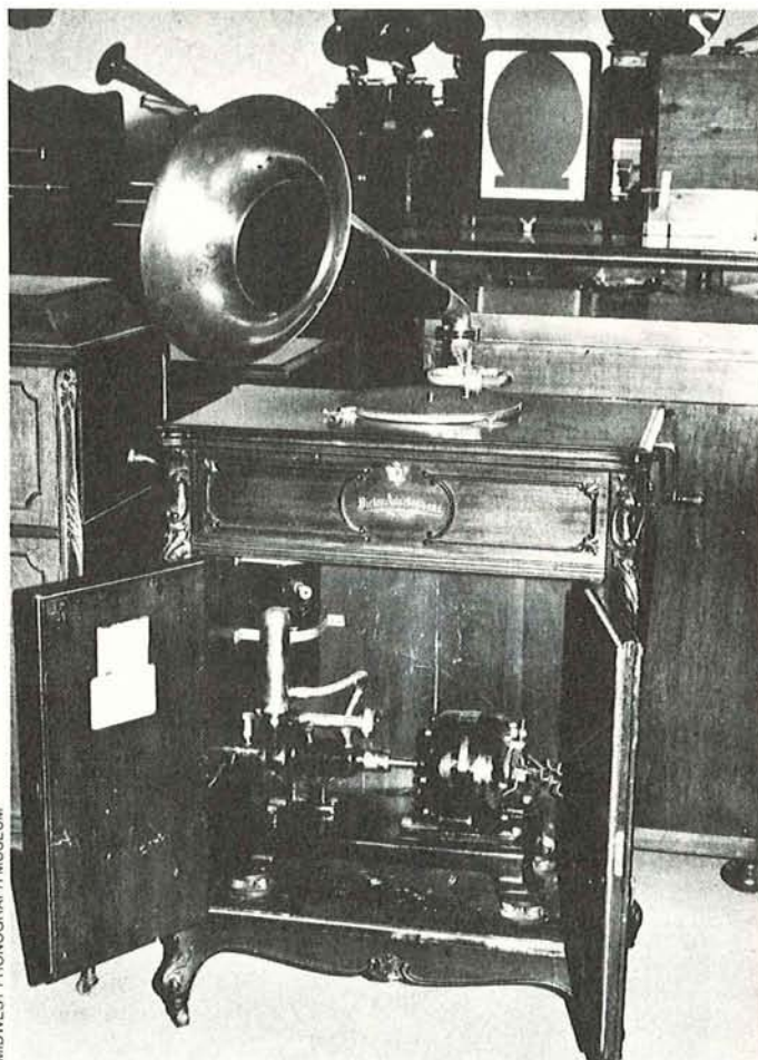
Tre versioni dell'«Auxetophone» ad aria compressa di Parsons. A sinistra, il prototipo del 1904; qui sotto, la versione commerciale venduta dalla Victor nel 1909 per $500; in fondo, un modello di transizione realizzato dalla Gramophone Co.
