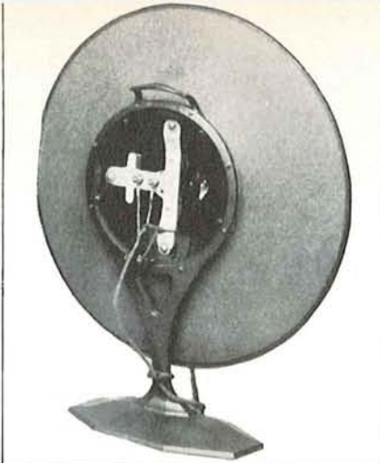
Nella colonna a sinistra, al centro, uno degli ultimi incisori acustici, in servizio presso la Gramophone Co. fino al 1924, con motore a peso, e, sotto, particolare dello stesso; in fondo, uno dei primi incisori grammofonici elettrici; il motore di trascinamento è ancora a peso.
