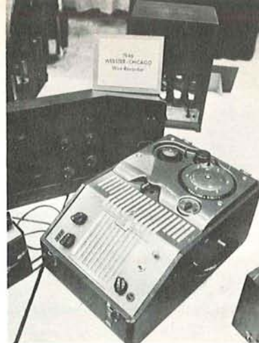
A sinistra: due versioni del Webster a filo d'acciaio: velocità 61 cm/s, 1946-47.
