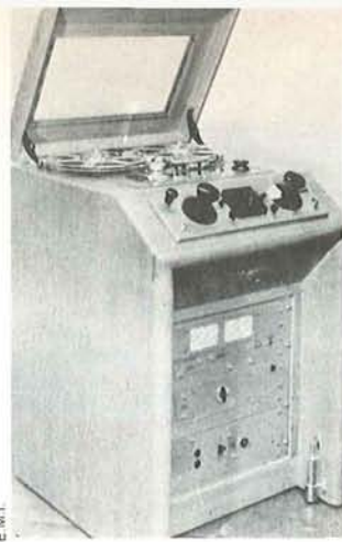
Sopra: una cartolina «Sonorine» degli anni Dieci dal dorso rivestito di cera per accogliere e recapitare messaggi sonori, ed un registratore a nastro magnetico E.M.I. TR-90 del 1957. Uno dei primi «magnetofoni» espressamente progettati per gli studi di radiotrasmissione. A fianco: Ipsophon a filo d'acciaio per la registrazione automatica di messaggi telefonici. Fabbricato dalla Oerlikon Machine-Tool Works, c. 1945.
